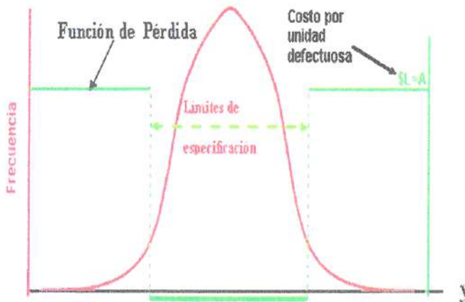
FIGURA 3 Aplicaciones industriales de la Función de Pérdida de Calidad de Taguchi Multivariante Función de Pérdida de calidad escalonada
